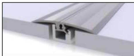
Da die Raumfeuchtigkeit und die Raumtemperatur je nach Jahreszeit variieren können, ist es notwendig, dass der Fußboden „arbeiten“ kann. Der Fußboden muss sich an allen Seiten ausdehnen und zusammenziehen können. Dieses Profil bietet dem Boden immer ausreichende Bewegungsfreiheit.
