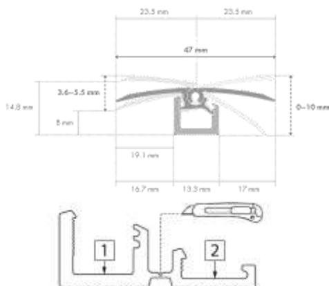
Das **Aluminiumprofil** besteht aus zwei Teilen, die man an der Bruchlinie voneinander trennt. Nehmen Sie das Profil fest in beide Hände und bewegen Sie es an einer Seite auf und ab. Tun Sie dies Schritt für Schritt über die gesamte Länge des Profils, bis beide Teile vollständig voneinander getrennt sind.
