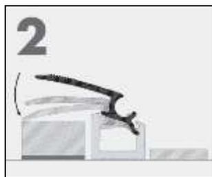
Platzieren Sie nun den unteren Teil des Aluminiumprofils in der Schiene. Der Flügel des Profils kommt dabei an die höchste Seite der Schiene.
