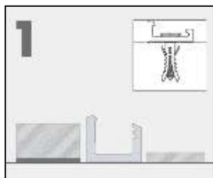
Befestigen Sie die Schiene mit Schrauben am Untergrund. Verwenden Sie dazu die vorgebohrten Öffnungen in der Schiene. Verwenden Sie Schrauben von 3x30 mm.
